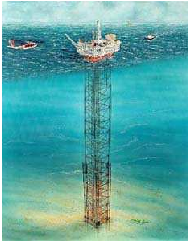
Fig. 2-1d. Sketch di traliccio (di tipo cedevole o compliant) in fondali non bassi per piattaforma petrolifera
