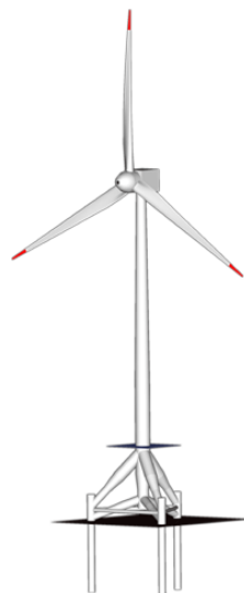
Fig. 3-3c. Schema di turbina da 5 MW su treppiede di tipo simile a quello del prototipo Multibrid
