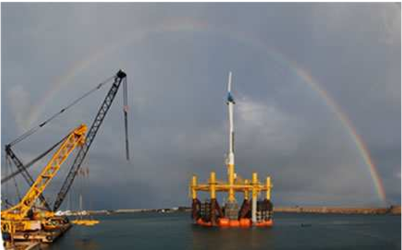
Fig. 2-5a. Turbina poggiante su struttura (da immergere e da tenere sommersa in profondità) al momento del trasporto in situ al largo di trifase nella sua prima sistemazione (BlueH)
