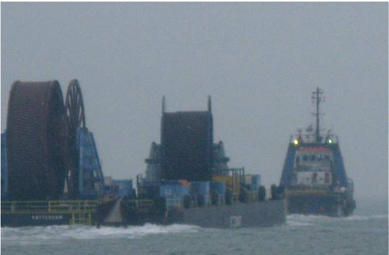
Fig. 3-1a. Mezzi installativi per cavo sottomarino
