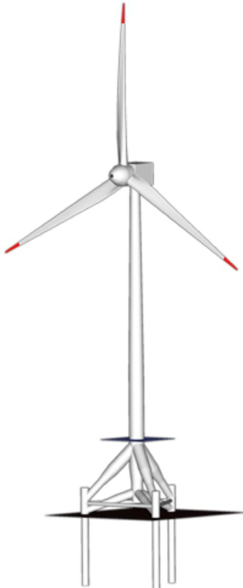
Fig. 2-11b. Schema di turbina su fondazione a tripode
