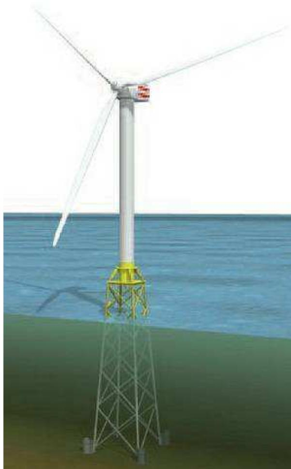
*Fig. 2-12. Schema di struttura portante con i tubi di guida dei pali di fondazione fissati al piede dei montanti*
