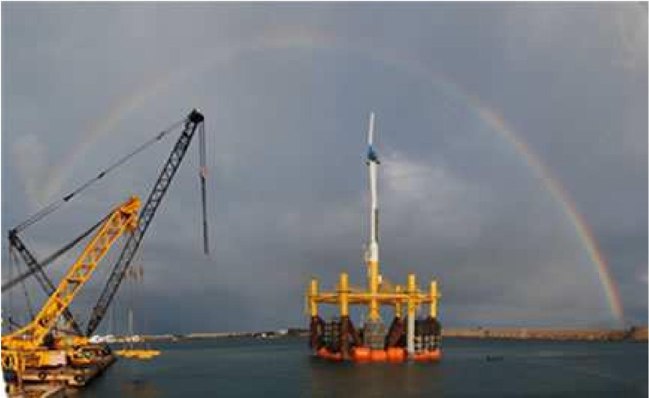
Fig. 2-5. Turbina poggiate su struttura (da immergere e da tenere sommersa in profondità) al momento del trasporto in situ al largo di Tricase (BlueH)
