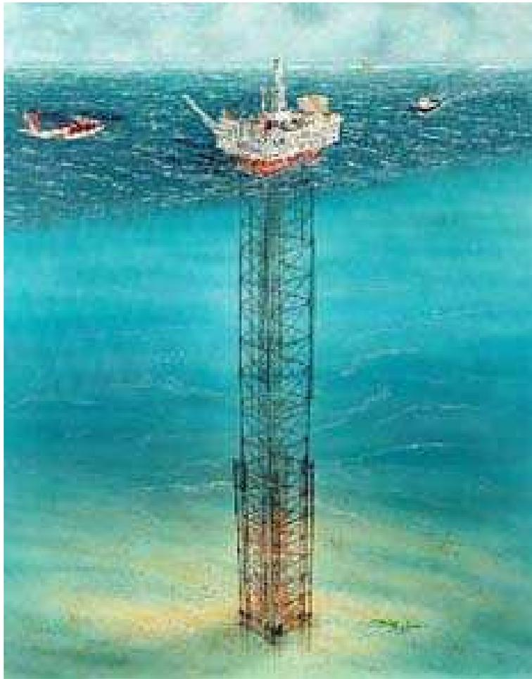
Fig. 2-11a. Sketch di traliccio (di tipo cedevole o compliant) in fondali non bassi per piattaforma petrolifera
