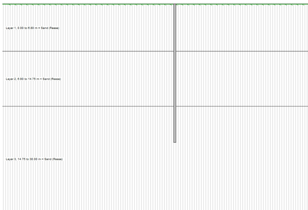
Figura 14.1 Modello di calcolo con software L-Pile
