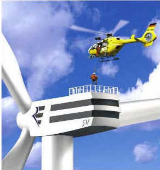
Fig. 6-2f. Atterraggio su navicella con cavo da elicottero (REpower)
