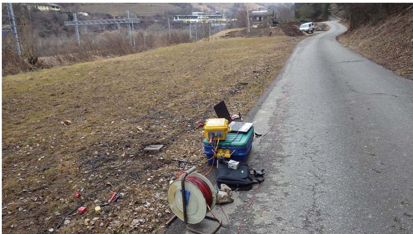
Fig. 5 - Stendimento sismico per registrazione MASW / Re.Mi.
