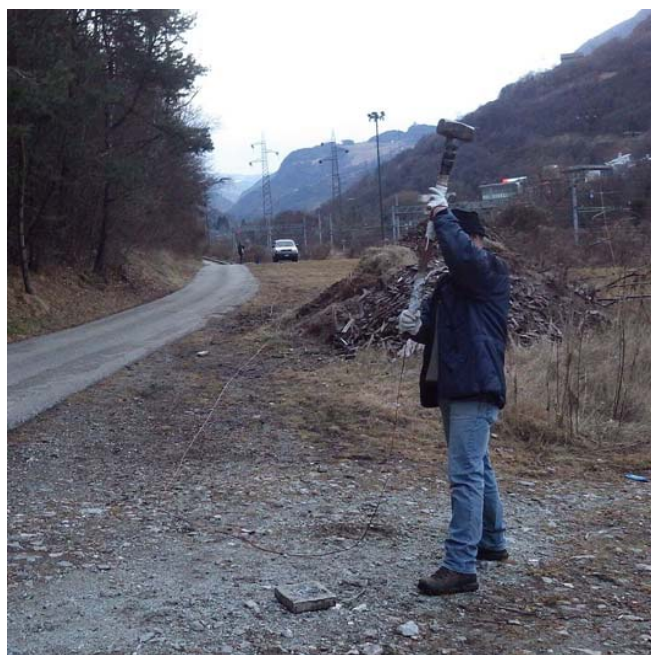
Fig. 6 - Energizzazione Prova MASW
