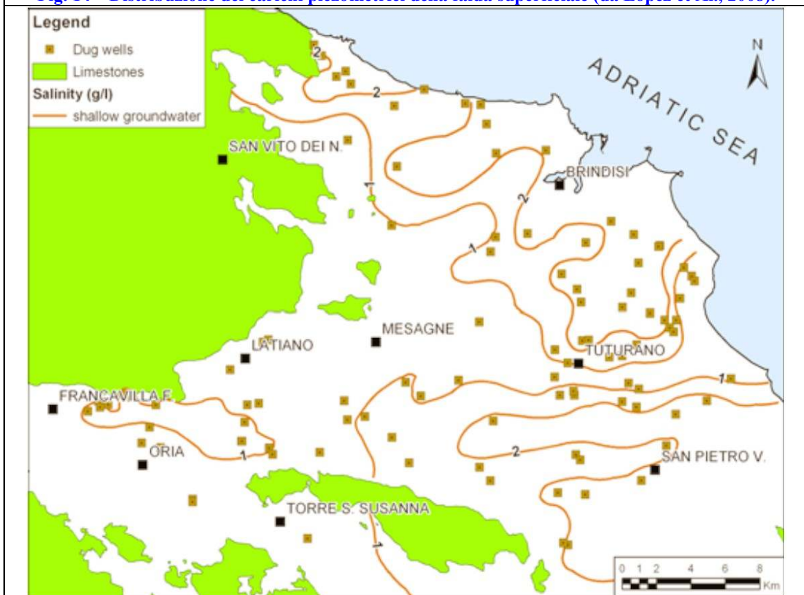
Fig. 15 – Distribuzione del contenuto salino delle acque della falda superficiale (da Lopez et Al., 2008).
