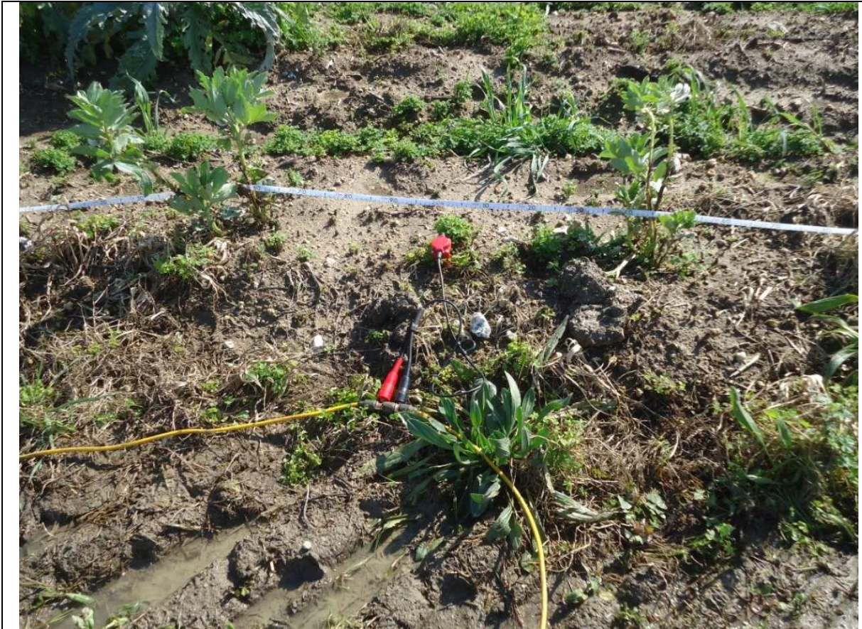
Foto 10 – Geofono da 4,5 Hz infisso nel terreno e collegato allo stendimento.
