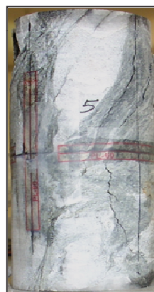
Foto dopo rottura
