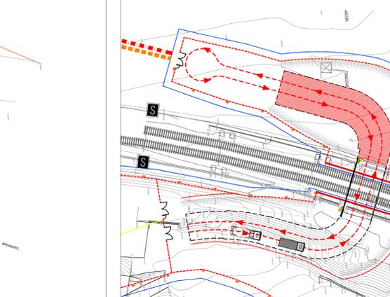
Si comincia a scavare dal primo tratto della rampa di progetto, lato est, fino ad arrivare alla quota di fondo scavo della platea del sottopasso. Andando avanti con gli scavi, viene eseguito il secondo ordine di chiudature per il sostegno del fronte di scavo. Viene in seguito scavato il sottopasso, e viene eseguito il profilo evidenziato con il tratteggio in planimetria.
