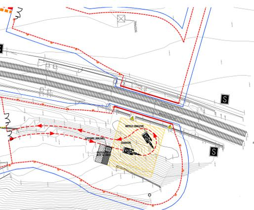
Sei comincia a scavare dal primo tratto della rampa di progetto, lato est, fino ad arrivare alla quota di fondo scavo della platea del sottopasso. Andando avanti con gli scavi, viene eseguito il secondo ordine di chiudature per il sostegno del fronte di scavo. Viene in seguito scavato il sottopasso, e viene eseguito il profilo evidenziato con il tratteggio in planimetria.
