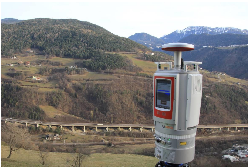
Figura 4. Strumentazione utilizzata per il rilievo Laser scanner del versante.
