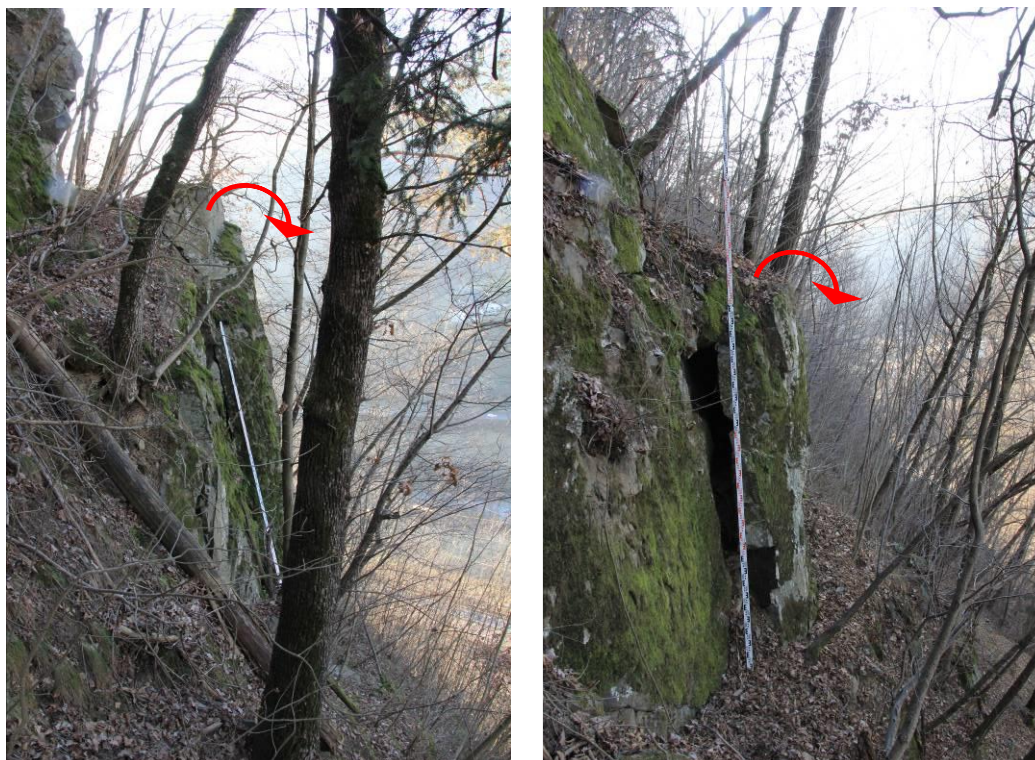
Figura 15. Rottura per ribaltamento di blocchi lastriformi, con fessura di trazione aperta.
