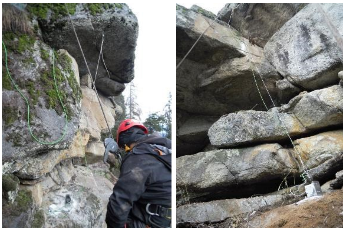
Fig. 4. Estensimetri a filo Fe3 e Fe4 installati rispettivamente nella porzione E ed W dell'affioramento roccioso.
