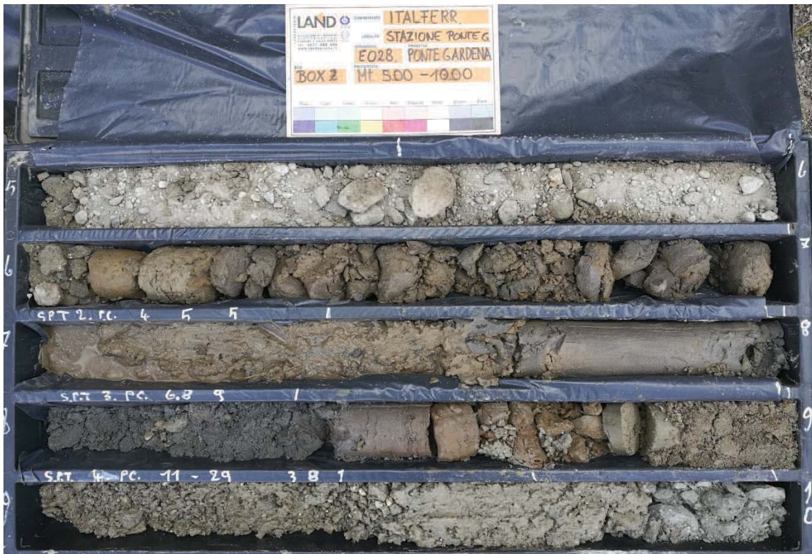
Ponte Gardena: E028 – Box 2 – m 5.00 ÷ m 10.00
