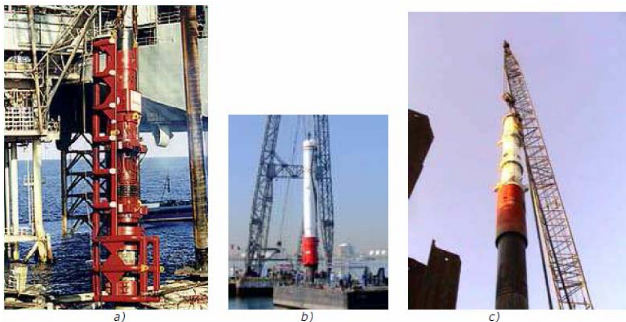
Fig. 4.56 : Tipologie di battipalo: a. battipalo ad azionamento diesel tipo Delmag (Wilkinson Technologies Ltd.); b. battipalo idraulico IHC generico e (c) di tipo IHC-SC30 (IHC Hydrohammer)
