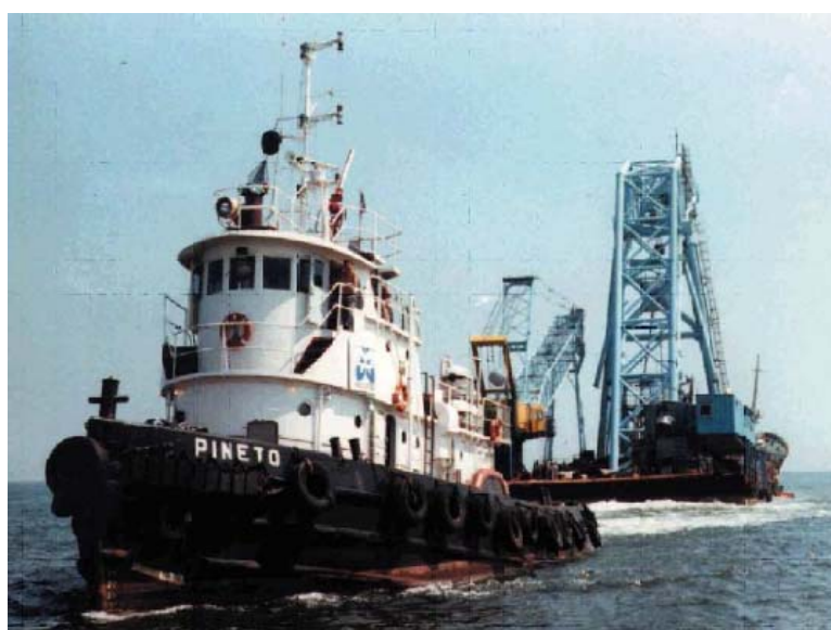
Fig. 4.27 : Trasporto di struttura in posizione verticale (Micoperi)
