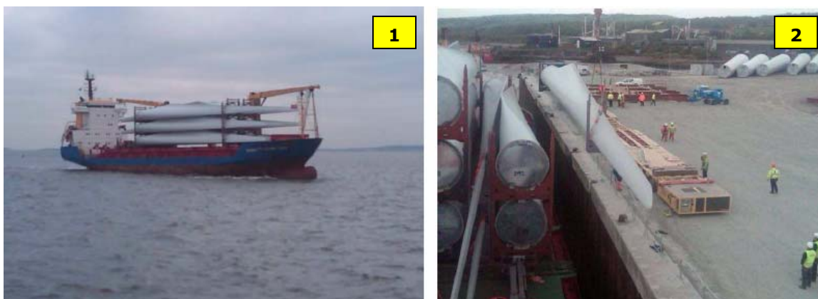
Fig. 4.8 : Pala (PN Rotor) in fase di carico su battello a Stade (DE), scarico da nave mediante trave di supporto in cantiere (Vestas) e movimentazione (3) per turbina 5M (Thornton Bank)
