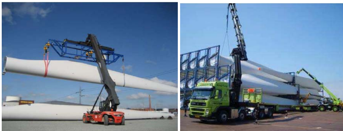
Fig. 4.10 : Movimentazione di pala con una o due gru d'estremità (Vestas)
