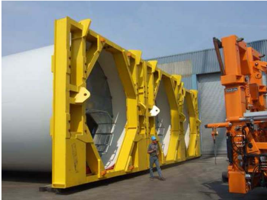
Fig. 4.23 : Trasferimento via nave di sezioni di torre per turbina 5M, i cui terminali consentono di tenerle in loco durante la navigazione e di guidarle durante l'installazione in loco (Liftra)
