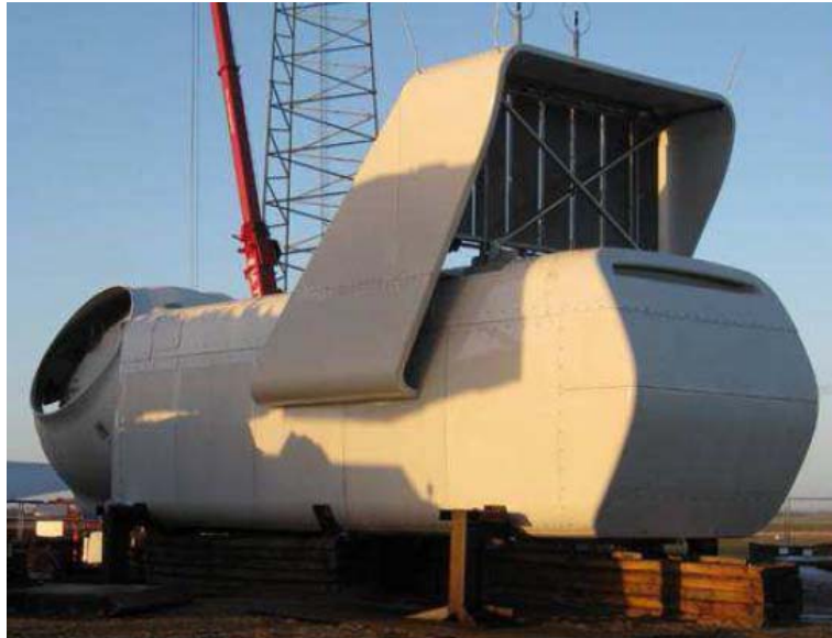
Fig. 4.14 : Completamento della navicella con mozzo e sistema di raffreddamento, collocato sul cielo dell'unità (Vestas)
