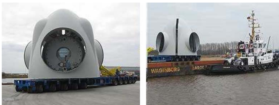
Fig. 4.70 : Trasporto a terra e su chiatta del musetto della navicella con il collegamento con l'asse rotorico (BARD VM)
