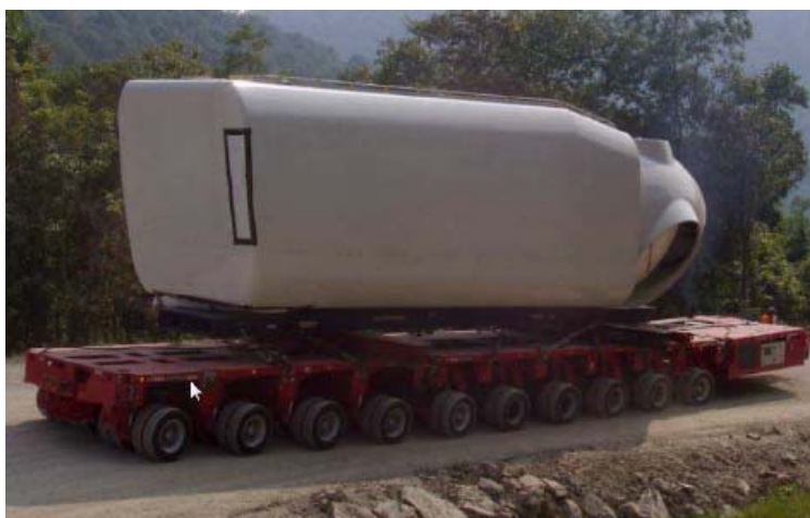
Fig. 4.13 : Navicella con mozzo su cocodrillo (Vestas)
