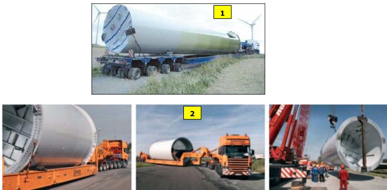
Fig. 4.3 : Movimentazione di parti di torre per turbina V112 (1) e 5M (2)
