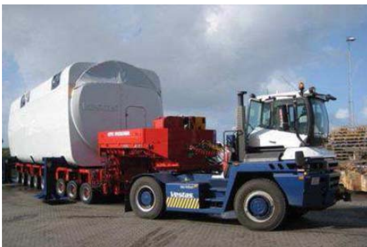
Fig. 4.12 : Navicella senza mozzo al traino di trattore
