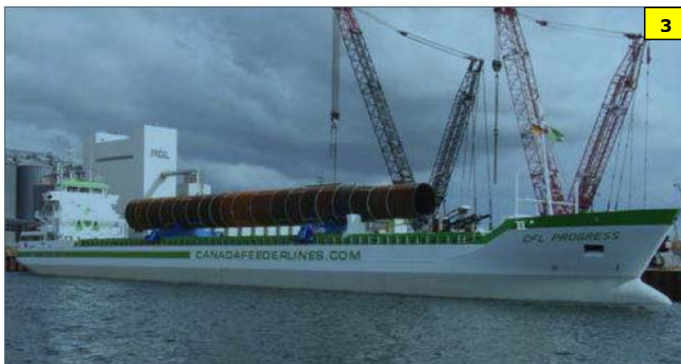
Fig. 4.9 : Primo trasporto di pale (1) verso il porto di Mostyn (Burbo Bank) con scarico delle stesse (2) e trasporto CPL Progress (3) per trasferire monopila verso il sito (Belwind)
