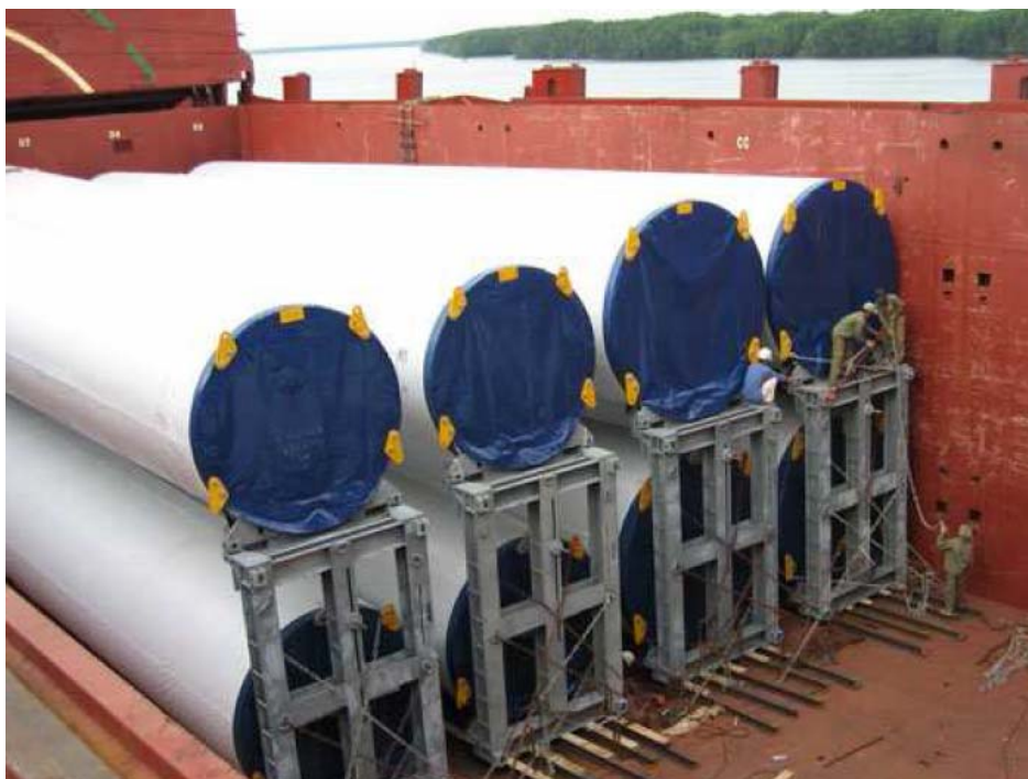
Fig. 4.24 : Stivaggio su due piani per tronchi di diametro e peso minori per turbina 5M (Liftra)
