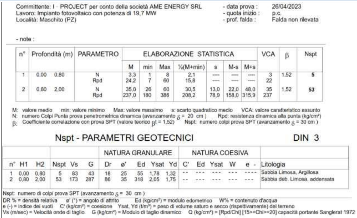
Figura 3: Elaborazione prova penetrometrica dinamica DPSH.3
