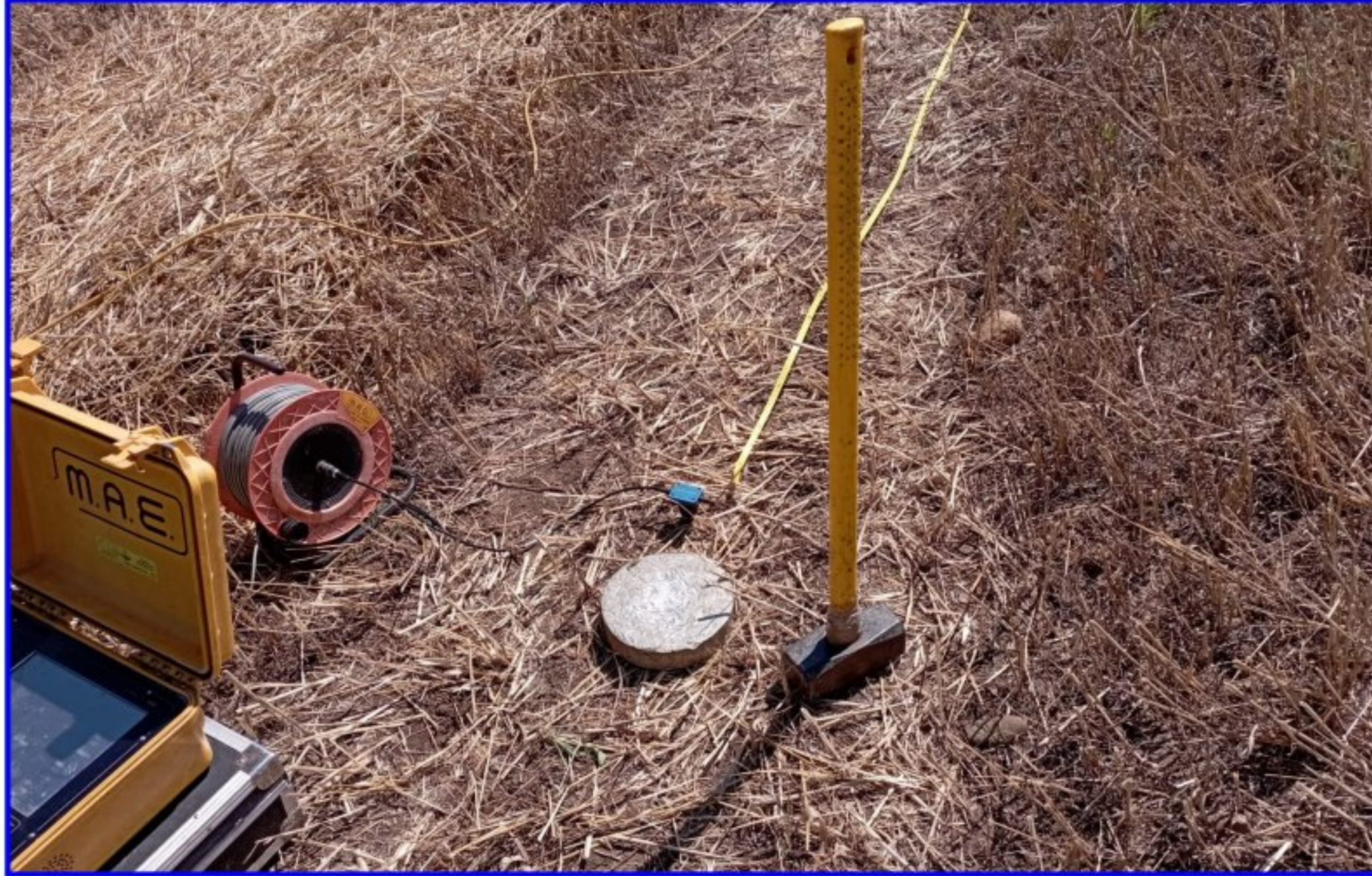
Fig. 5 – Sorgente energizzante, costituita da massa battente su piastra di alluminio. Come starter/trigger è stato utilizzato un geofono verticale Geospace a 14Hz.
