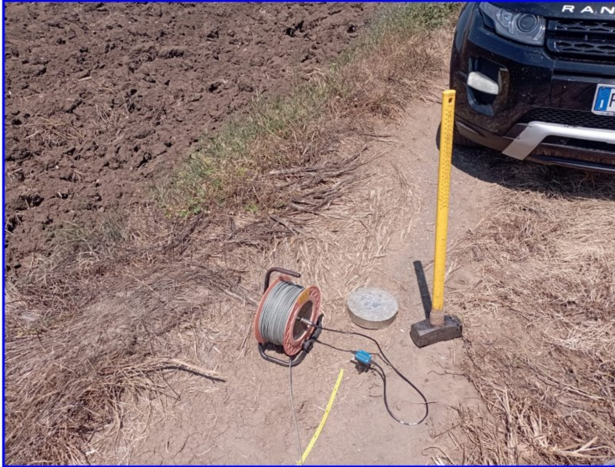
Fig. 3 – Sorgente energizzante, costituita da massa battente su piastra di alluminio. Come starter/trigger è stato utilizzato un geofono verticale Geospace a 14Hz.
