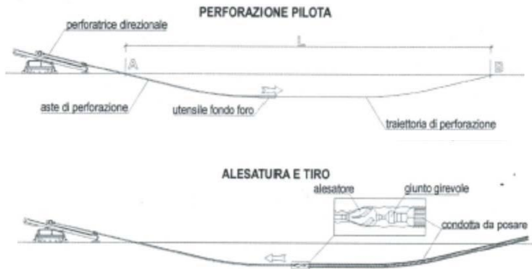
Schema semplificato del sistema di trivellazione T.O.C.
