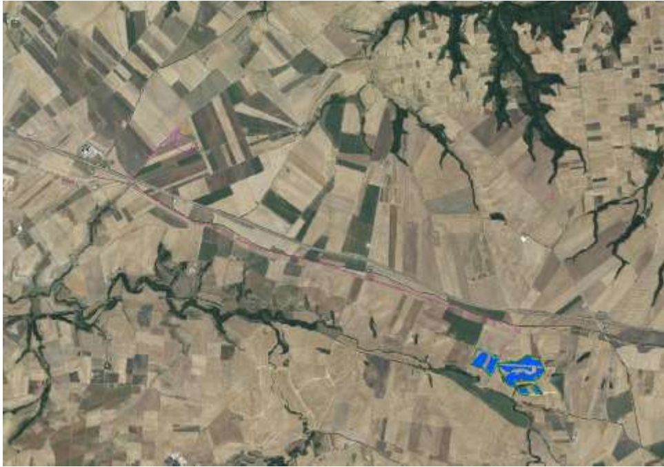
Figura 1 - impianto ftv e cavidotto 36 kV su ortofoto
