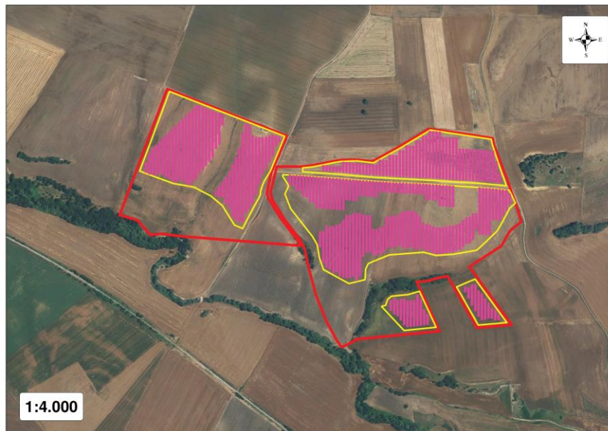
Figura 10 – Area di progetto con l’indicazione del posizionamento dei moduli fotovoltaici.
