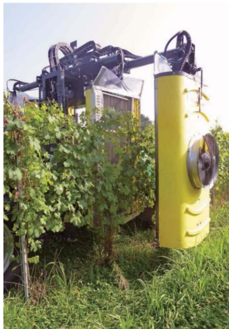
Foto 5 - pompa irroratrice a polverizzazione pneumatica con diffusore anti-deriva
