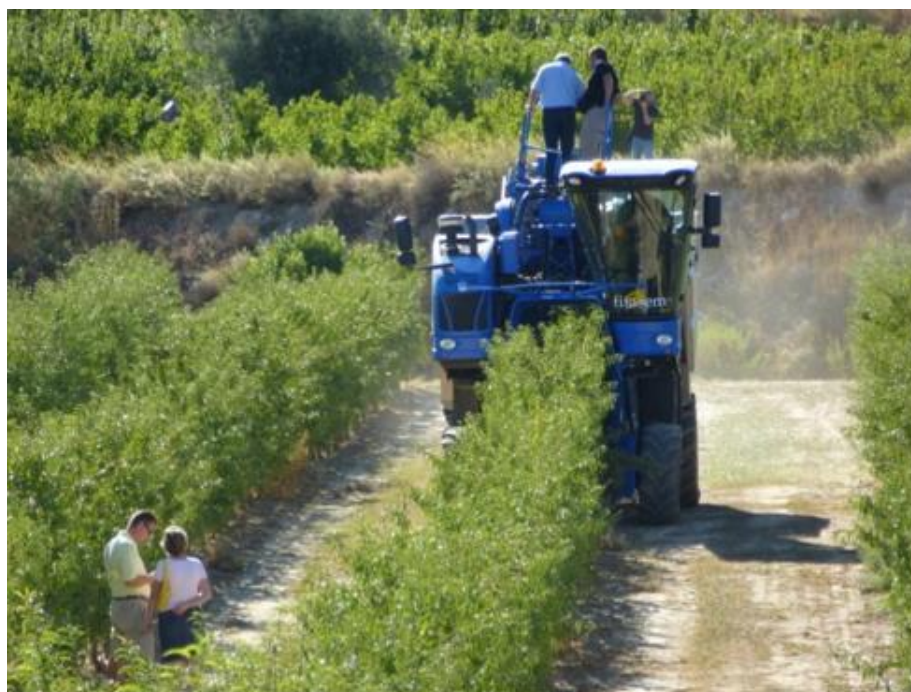
Foto 6 - Macchina scavallatrice durante le operazioni di raccolta in mandorleto superintensivo a siepone
