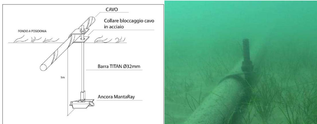
Fig. 3.11 Dispositivo di fissaggio del cavo a fondale ricco di flora
