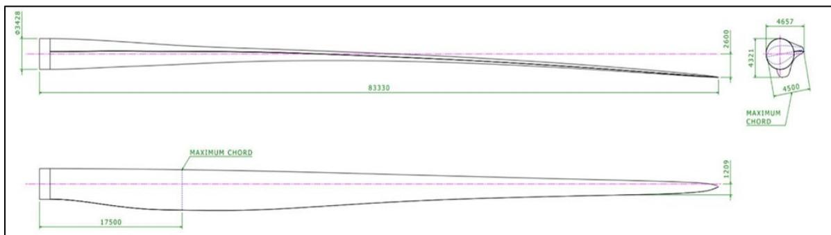
Figura 22 - Dettaglio lama eolica
