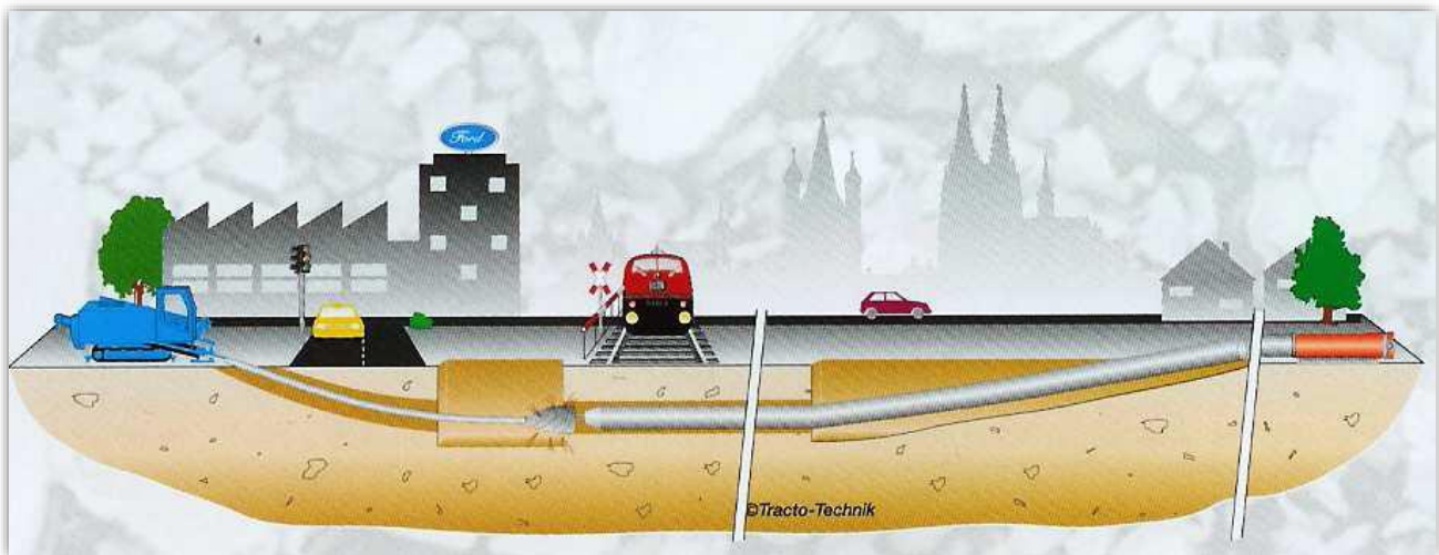
Fig. 8. Schema di principio dell’attraversamento in T.O.C.
