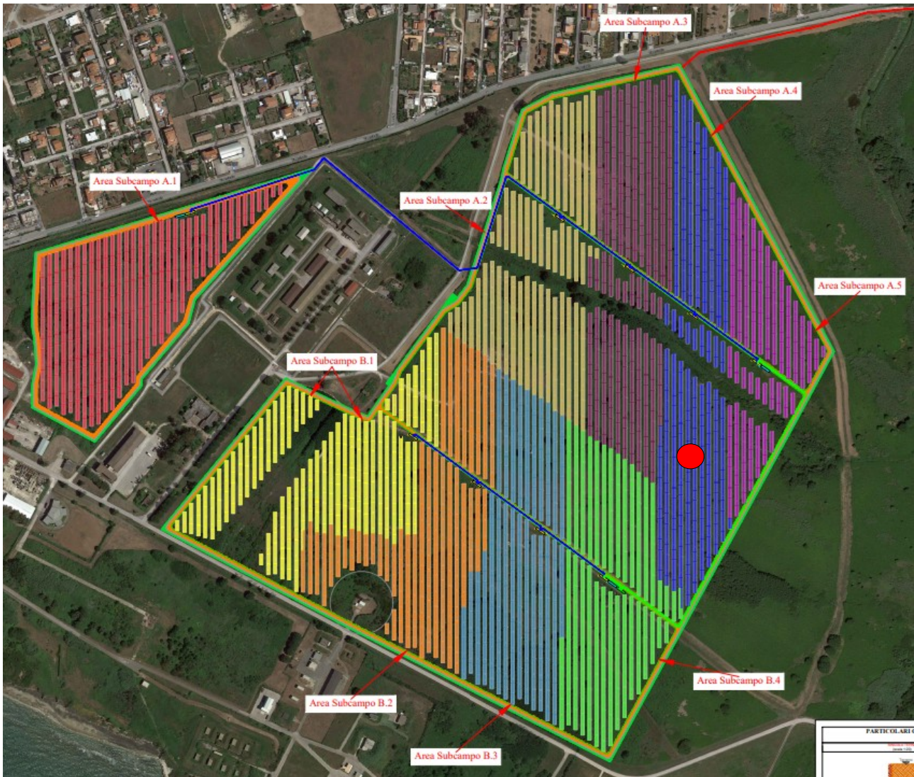
Fig. 6. Posizione della Cabina di raccolta contrassegnata con cerchio rosso; inoltre, vengono rappresentati tutti i subcampi con colori diversi
