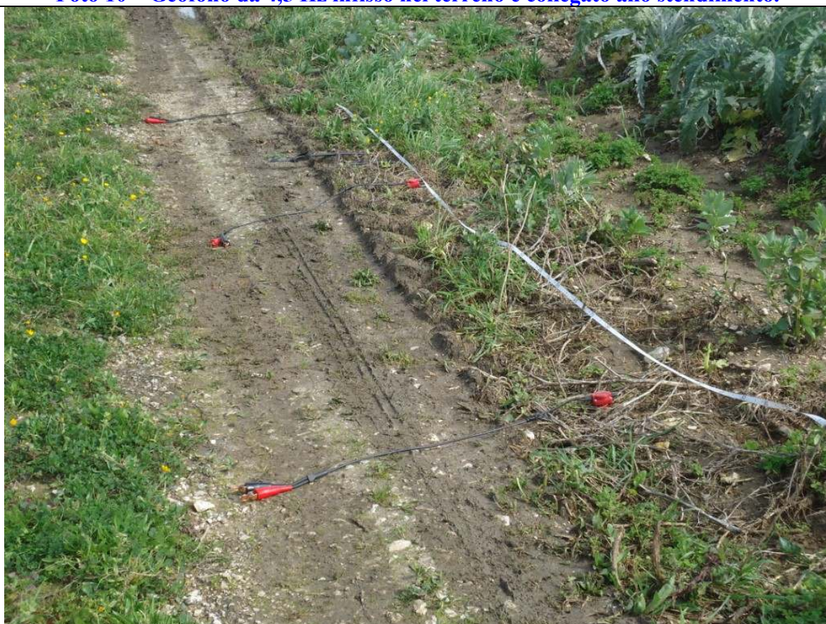
Foto 11 – Particolare della linea di stendimento.
