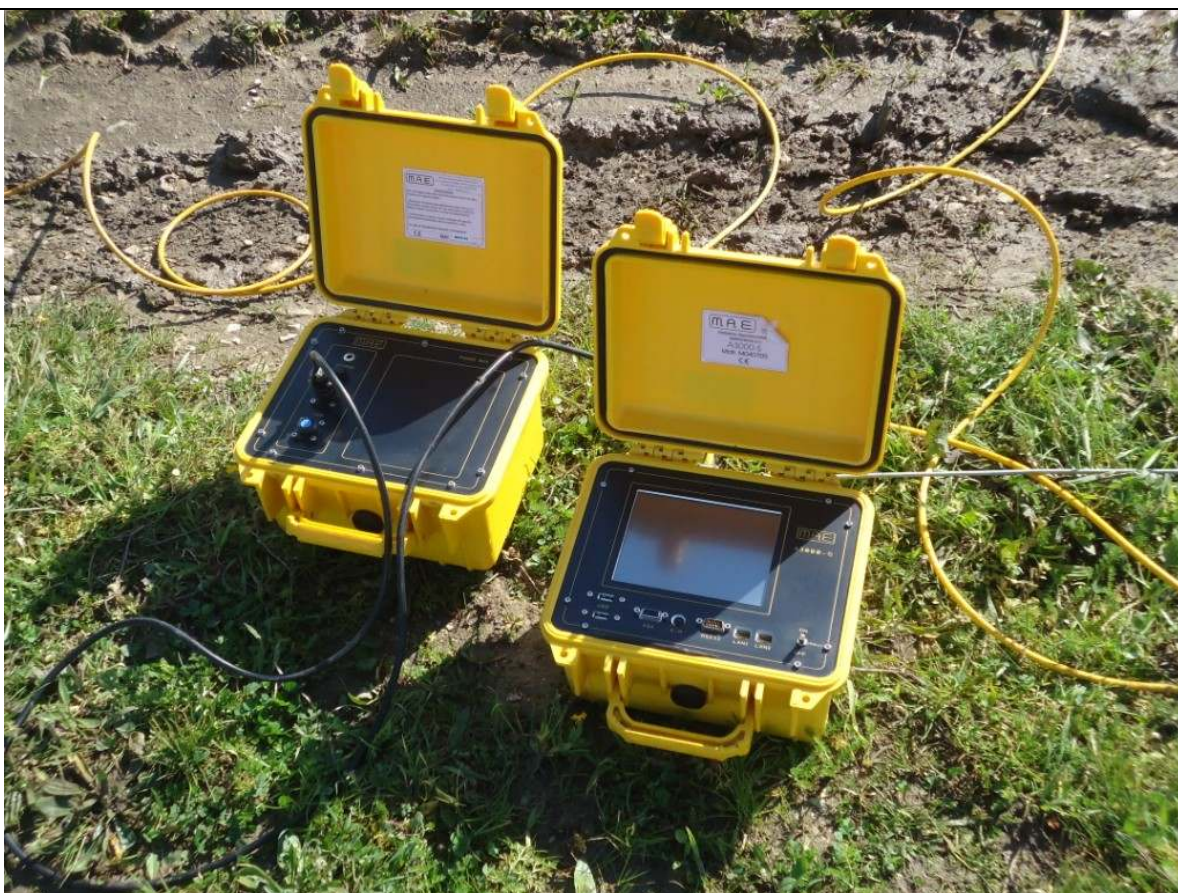
Foto 9 – Sismografo utilizzato per l'esecuzione dell'indagine MASW.
