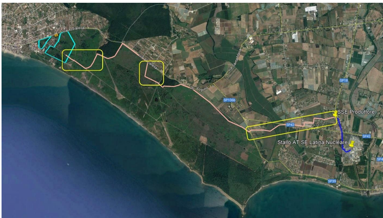
Figura 3-12 – Prima versione del tracciato di elettrodotto. In evidenza i tratti di attraversamento di aree agricole e/o verdi.
