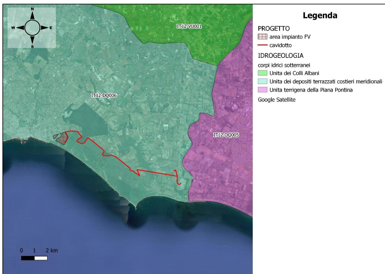
Figura 2.39 - Schema cartografico concernente i corpi idrici sotterranei perimetrati nell'ambito territoriale della Regione Lazio, con focus sul settore in esame (fonte: ARPA Lazio).
