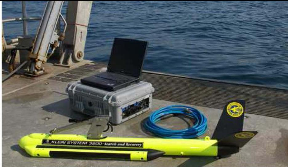
Specifiche tecniche: frequenza acustica: 445 - 900 kHz; beams orizzontali: 0.21°; verticali 40°; 500 Watt; ingresso per GPS (Global Positioning System); range di scala 12 valori da 10 a 200m; range massimo 150 metri a 445 KHz, 50 metri a 900 kHz; ingresso per compensatore d'onda; dimensioni: altezza 8.9 x larghezza 122; peso: 29 kg.
