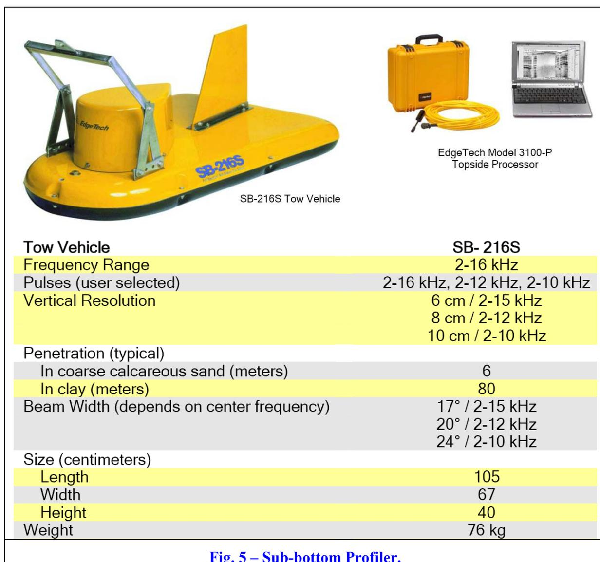
**Fig. 5 – Sub-bottom Profiler.**
