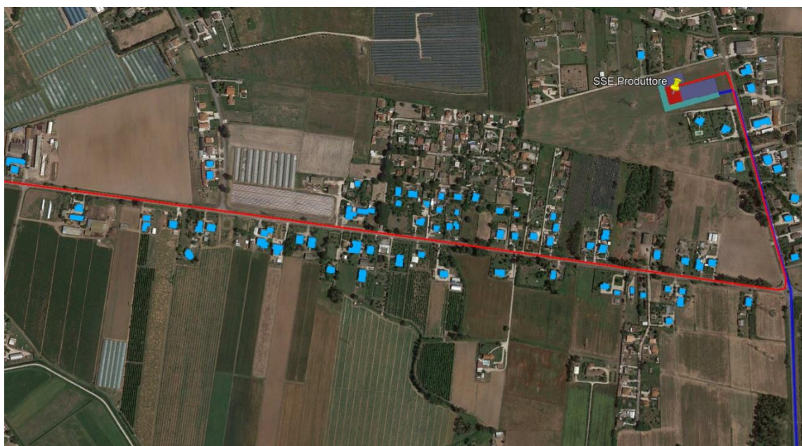
Figura 6-7 Ricettori residenziali più prossimi al tracciato di scavo per la posa dell'elettrodo interrato.
