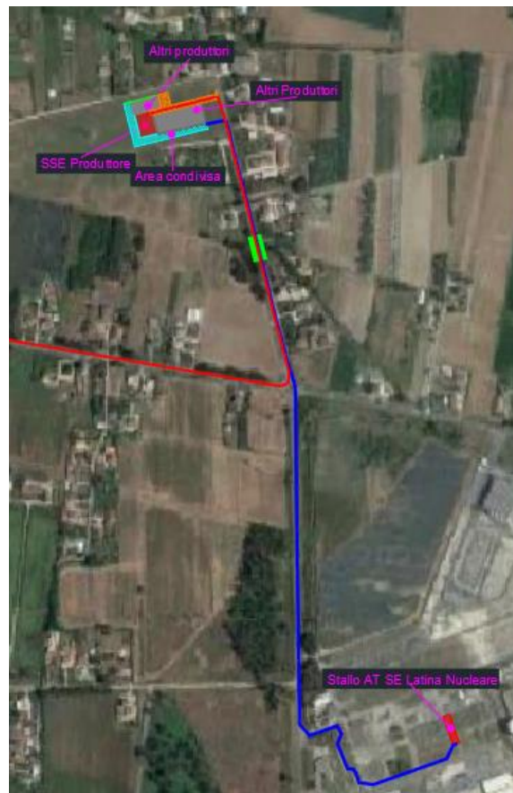
Fig. 4. Area di ubicazione della sottostazione produttore. In rosso elettrodotto dorsale di collegamento in MT 30 kV proveniente dal campo FV; in rosso la SSE produttore; in blu l'elettrodotto AT 150 kV di collegamento della SSE allo stallo TERNA.
