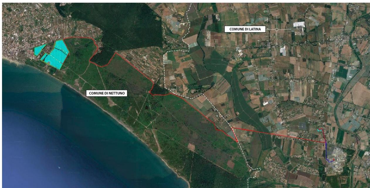
*Figura 2.3 - Planimetria su ortofoto del progettato impianto Fotovoltaico: in ciano è riportata l'area del generatore fotovoltaico, in rosso l'elettrodotto dorsale MT di collegamento tra l'impianto e la SSE.*
