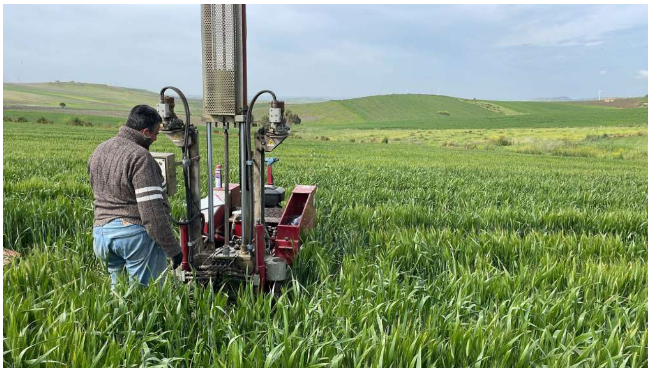
Prova DPSH 4 eseguita in situ
