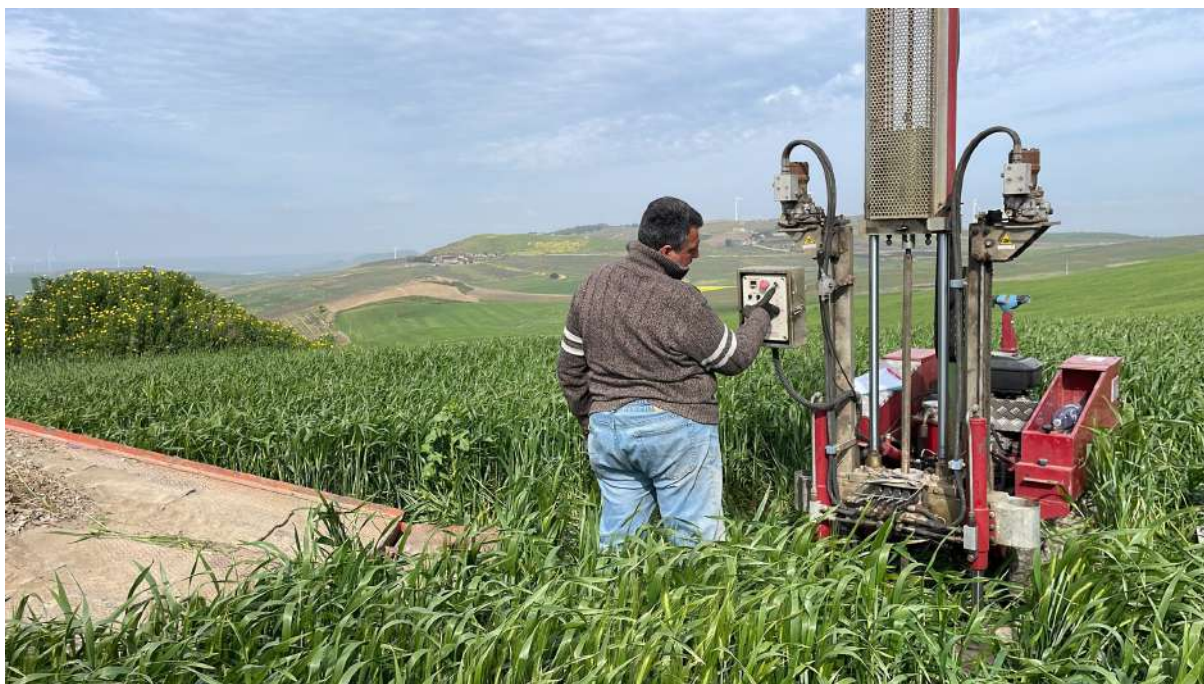
Prova DPSH 2 eseguita in situ
