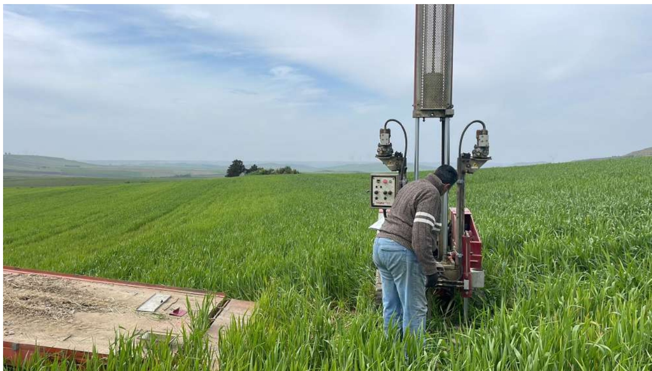
Prova DPSH 6 eseguita in situ
