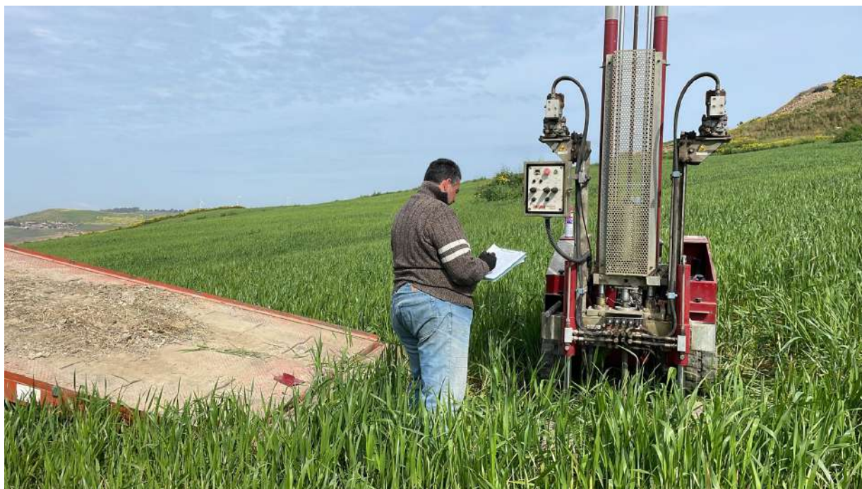
Prova DPSH 3 eseguita in situ
