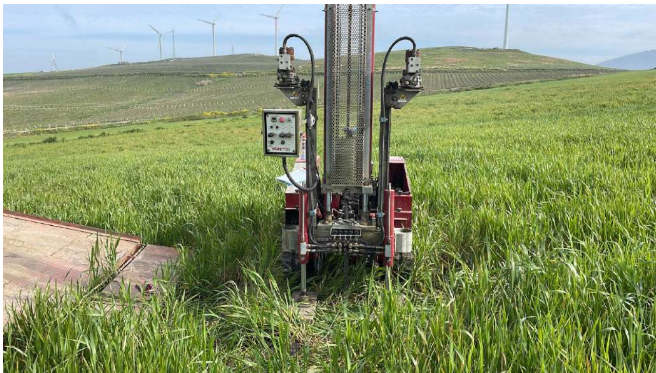
Prova DPSH 1 eseguita in situ
