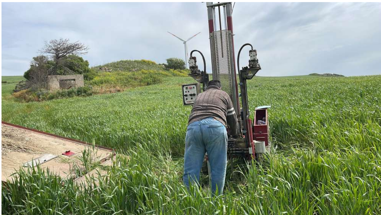
Prova DPSH 7 eseguita in situ
