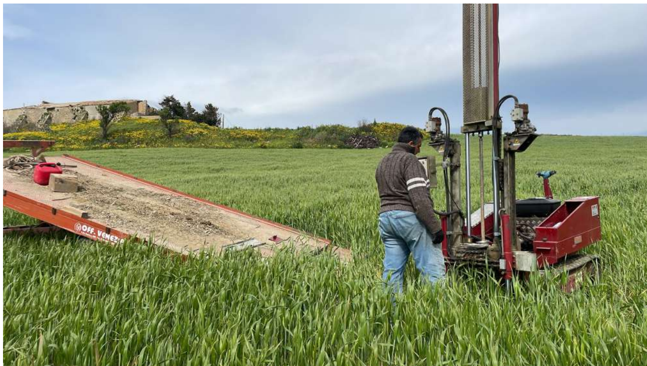
Prova DPSH 8 eseguita in situ
