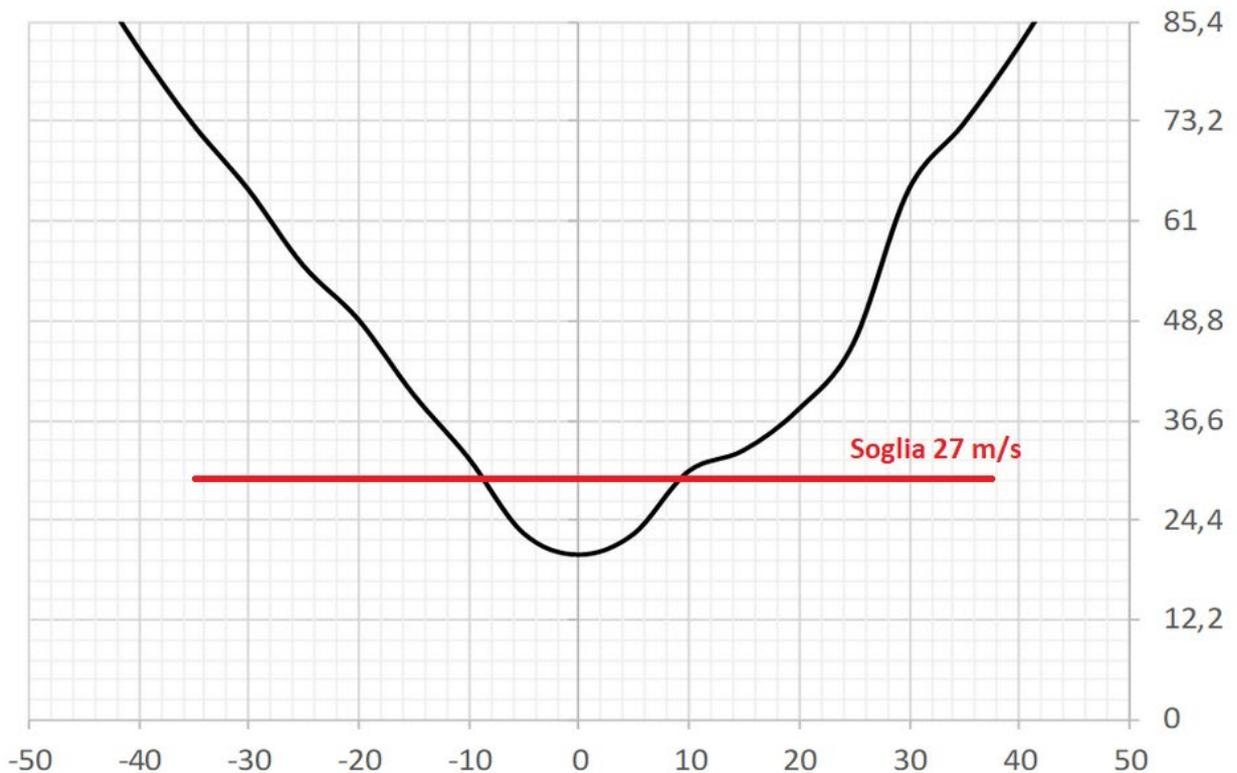
nel grafico soprastante viene riportato l'angolo minimo necessario ad ottemperare il requisito di 27m/s pari a circa un tilt di 10°.
