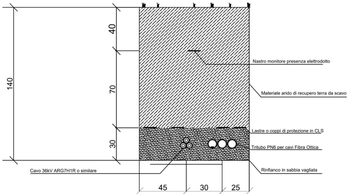
Figura 6 – Sezione tipo su terreno vegetale
