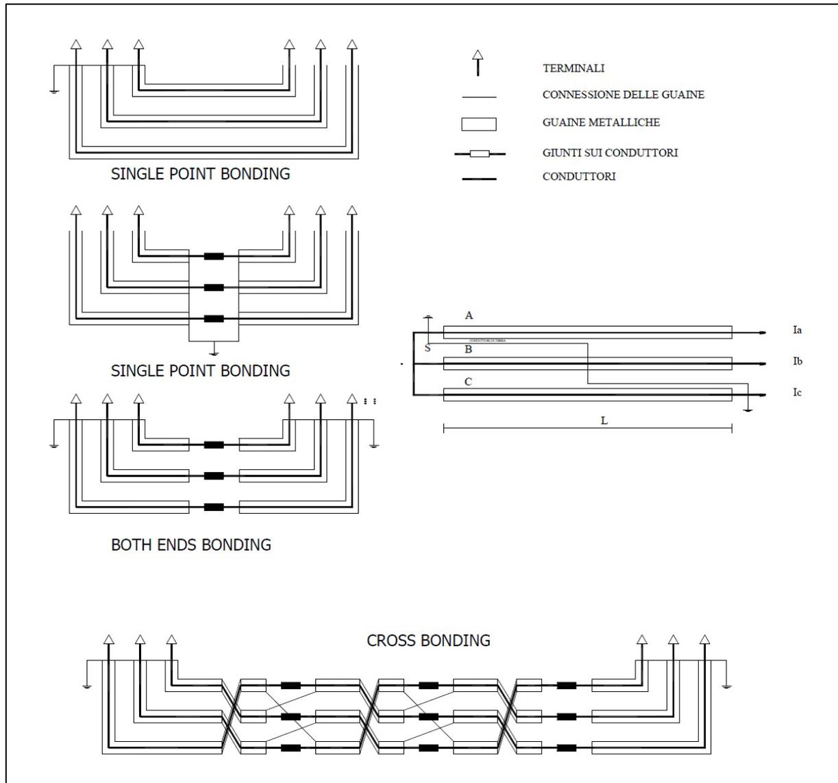
Figura 7 – Schema di connessione delle guaine metalliche
