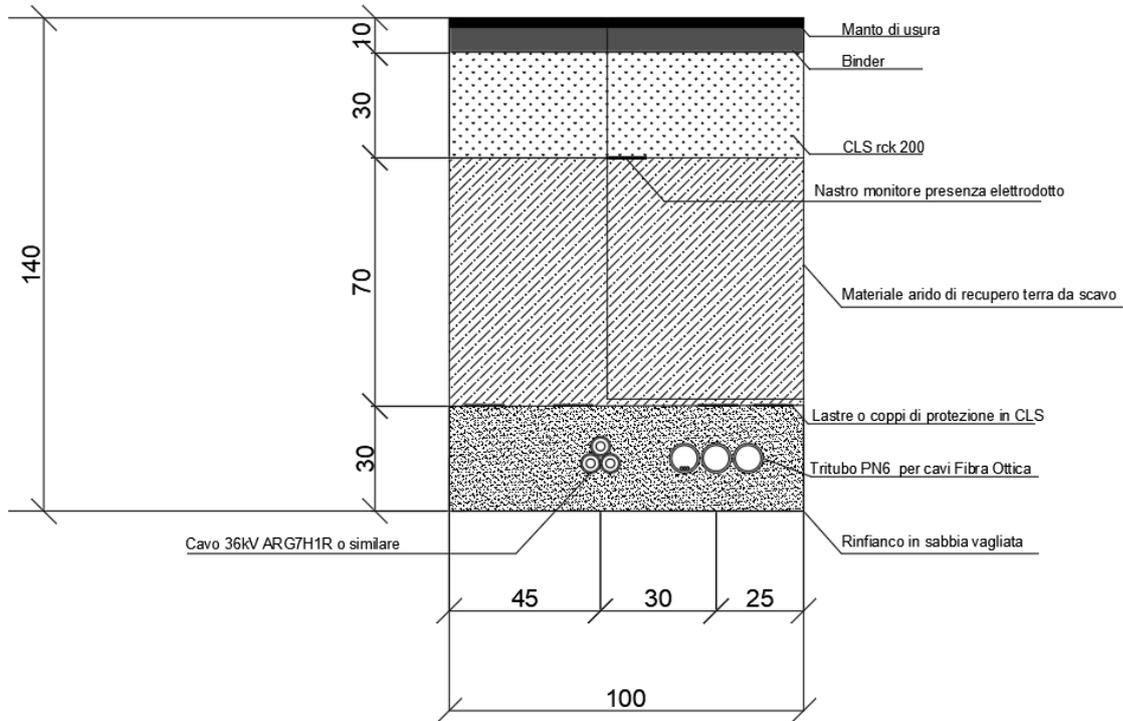
Figura 5 – Sezione tipo su manto stradale
