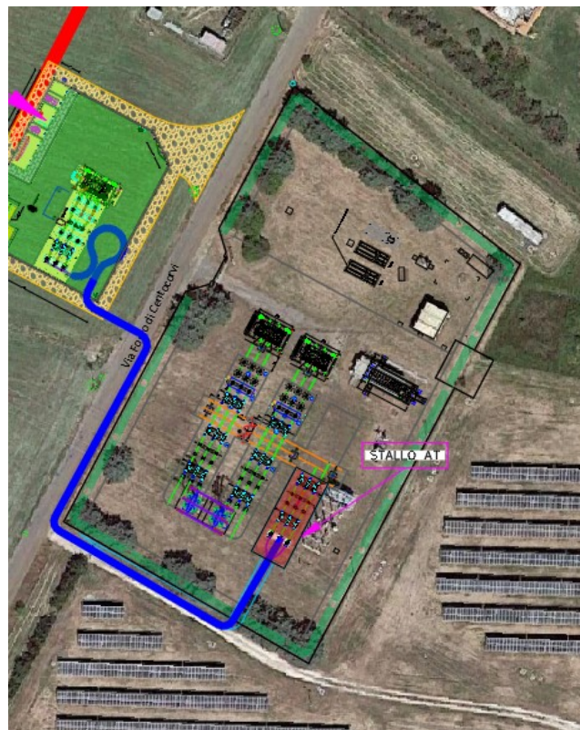
Fig. 33. Posizionamento dello stallo di connessione alla RTN
