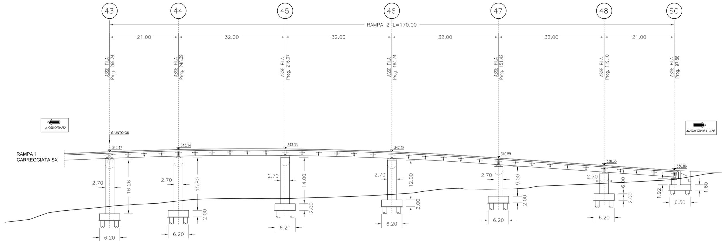
N.B. : GLI INTERASSI PILE SONO MISURATI SULL'ASSE IMPALCATO
