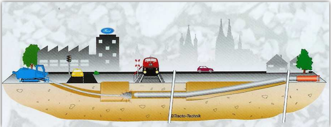
Fig. 8. Schema di principio dell'attraversamento in T.O.C.
