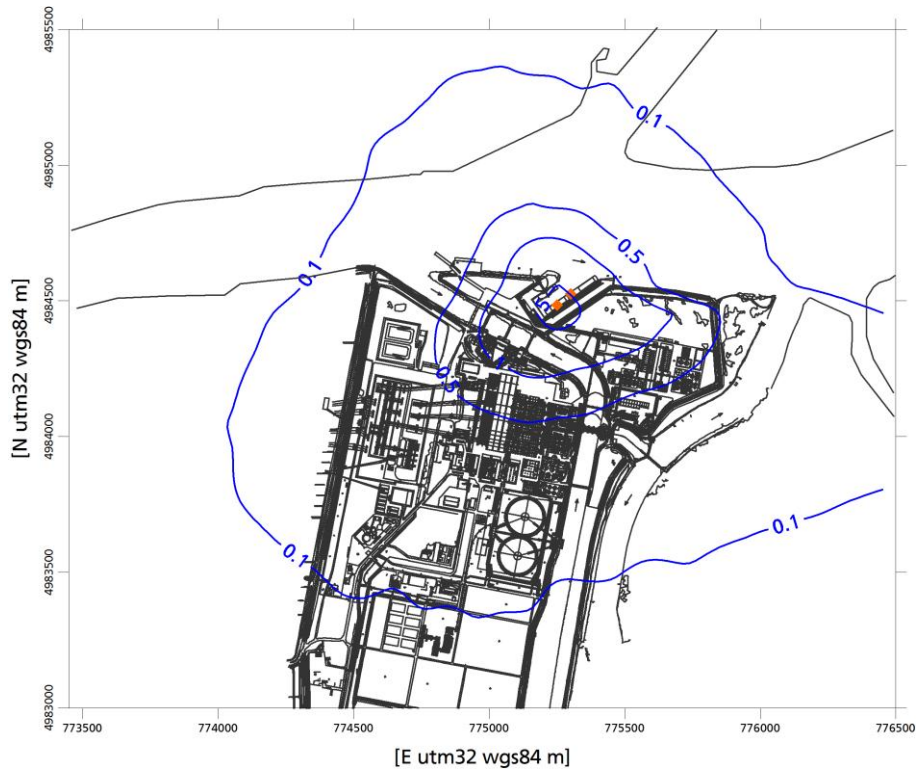
Figura 4.2.12 – Concentrazione media annua di PM 10 [µg/m 3 ] dalle emissioni degli scaricatori (punti arancioni) di carbone e calcare
