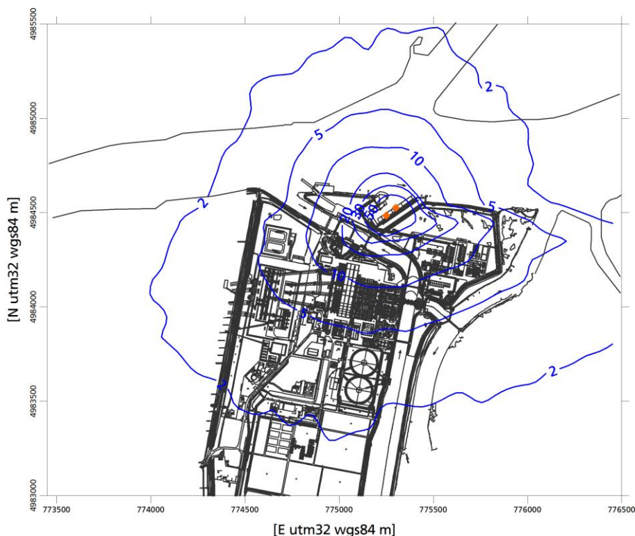
Figura 4.2.13 – Concentrazione giornaliera di PM 10 superata 35 volte [µg/m 3 ] dalle emissioni degli scaricatori (punti arancioni) di carbone e calcare
