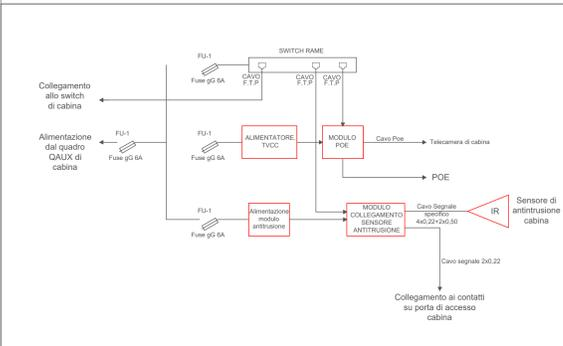
SCHEMA DI PRINCIPIO QUADRO DI ALIMENTAZIONE E CONVERSIONE TVCC E BARRIERE ANTIFURTO - QAC -
