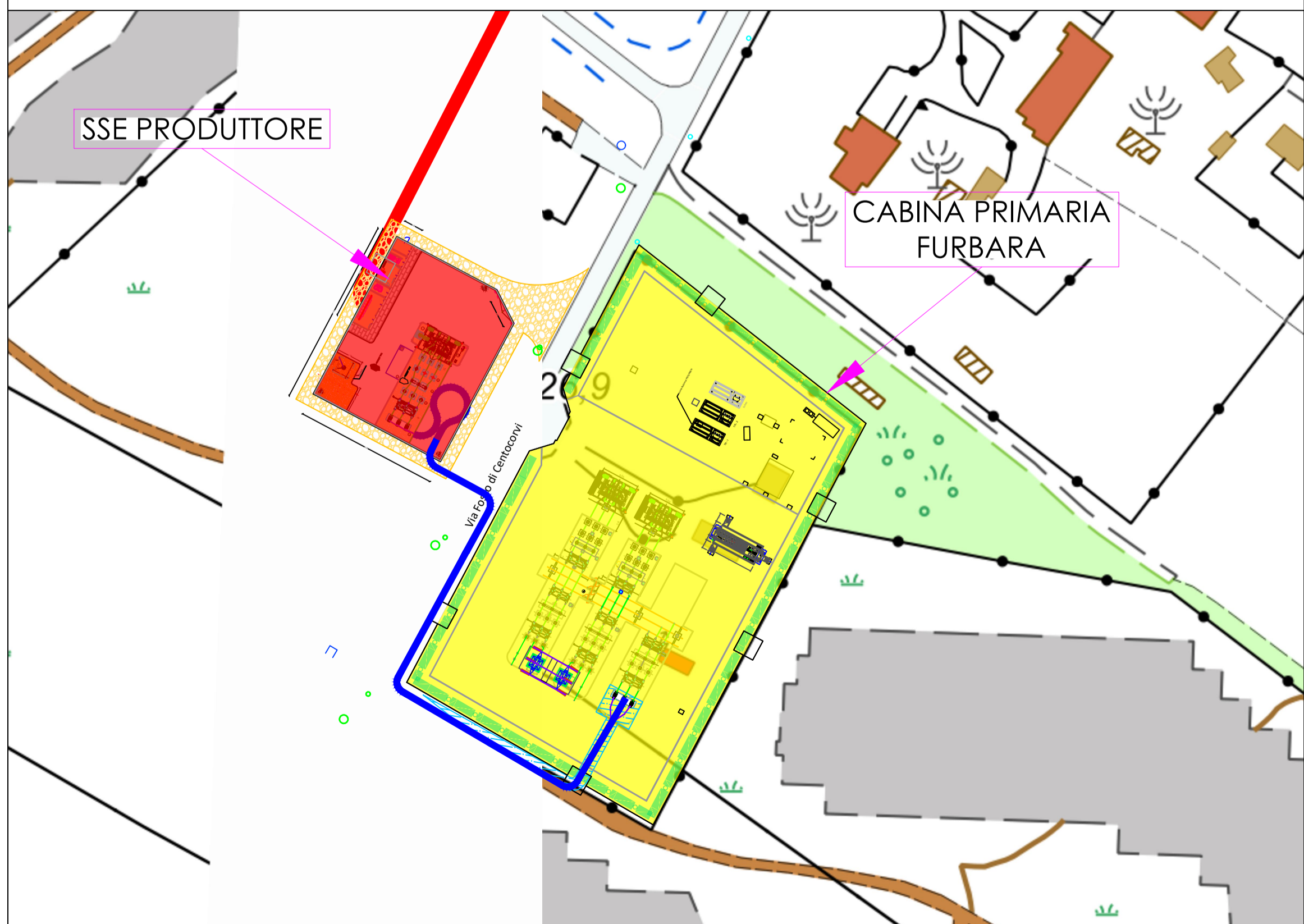
DETTAGLIO SOTTOSTAZIONE SU CARTA TECNICA REGIONALE- SCALA 1:1.000
