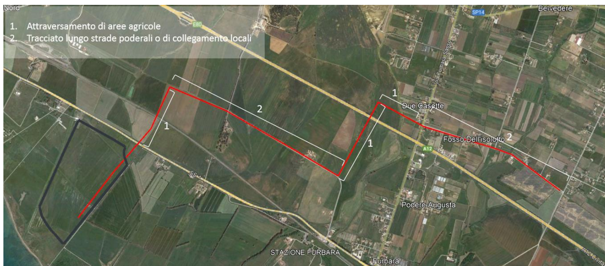
Figura 3-14 – Primo tracciato di elettrodotto.
