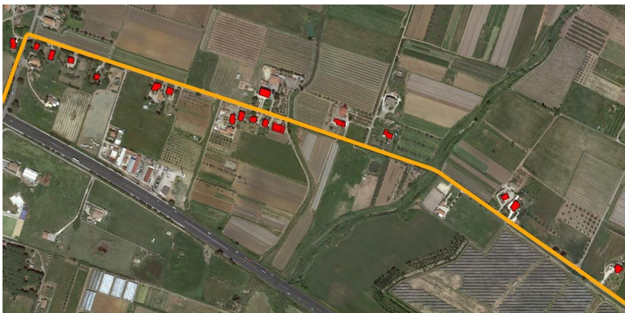
Figura 6-7 – Ricettori residenziali più prossimi al tracciato di scavo per la posa dell'elettrodo interrato.
