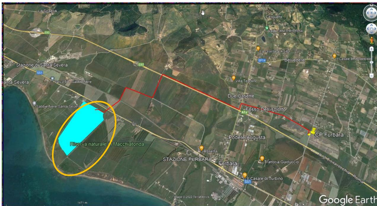
Figura 1-1- planimetria su ortofoto del progettato impianto Fotovoltaico: sulla destra la CP "FURBARA", accanto alla quale si prevede di posizionare la SSE Utente
