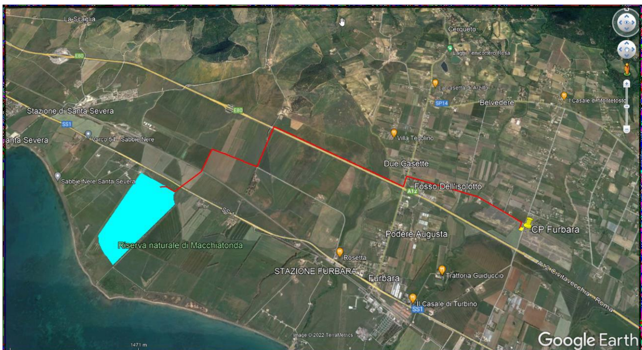
Figura 6-1 Planimetria su ortofoto del progettato impianto Fotovoltaico: sulla destra la CP "FURBARA", accanto alla quale si prevede di posizionare la SSE Utente
