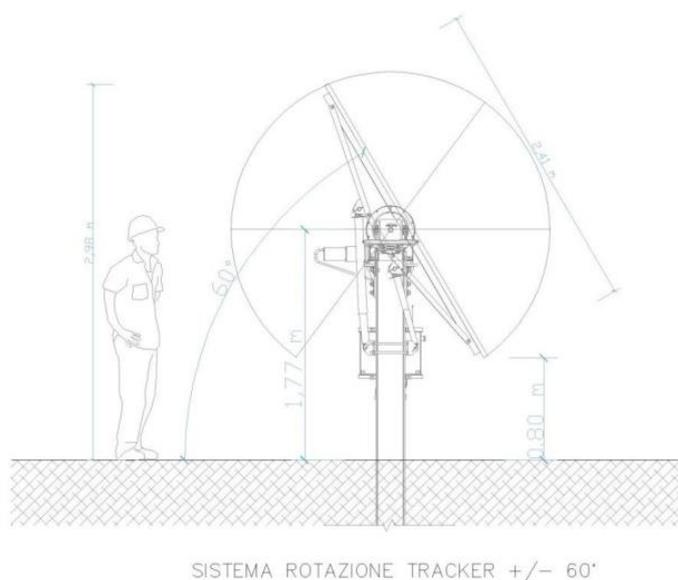
Figura 5 Dettaglio del sistema di rotazione tracker
