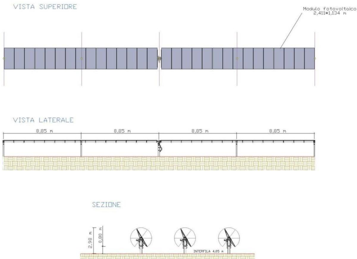
Figura 4 Sezione trasversale dell'impianto agri-voltaico
