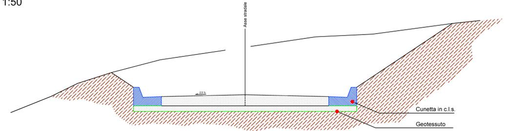
Sezione tipica "in scavo" - SCALA 1:50
