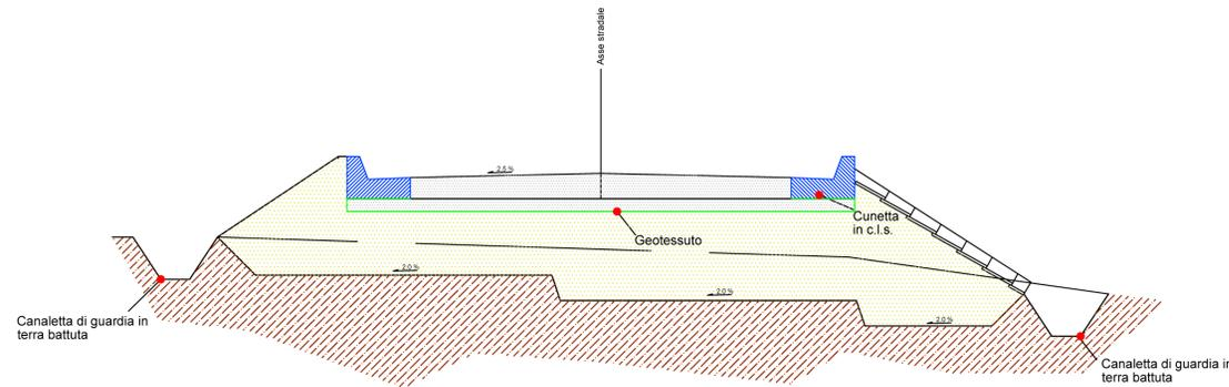
Sezione tipica "in rilevato" - SCALA 1:50
