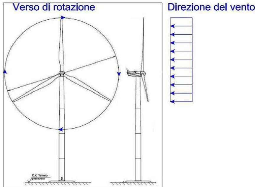
**Figura 1:** Relazione tra la direzione del vento ed il verso di rotazione del rotore
