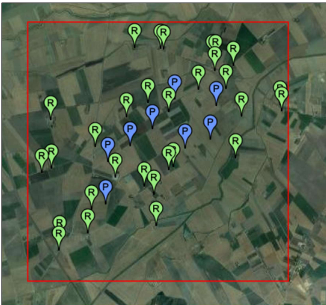
Figura 6: Dominio di calcolo con posizionamento di sorgenti (P) e ricettori (R)
