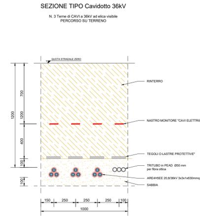
**SEZIONE TIPO Cavidotto 36kV su strada massicciata - Scala 1:20**
