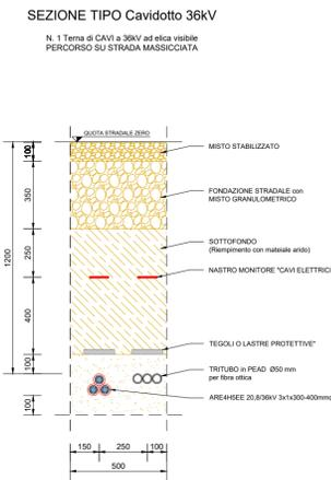
**SEZIONE TIPO Cavidotto 36kV su strada massicciata - Scala 1:20**
