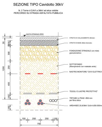
**SEZIONE TIPO Cavidotto 36kV su strada asfaltata - Scala 1:20**
