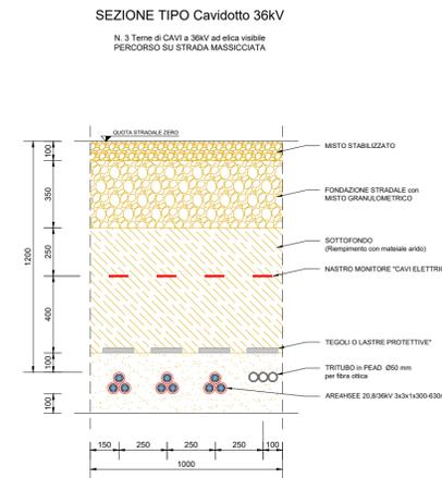
**SEZIONE TIPO Cavidotto 36kV su strada asfaltata Privata - Scala 1:20**
