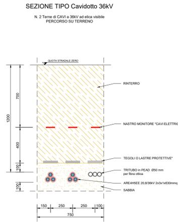
**SEZIONE TIPO Cavidotto 36kV su terreno - Scala 1:20**
