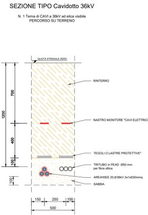
**SEZIONE TIPO Cavidotto 36kV su terreno - Scala 1:20**
