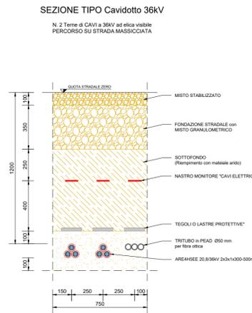
**SEZIONE TIPO Cavidotto 36kV su strada massicciata - Scala 1:20**
