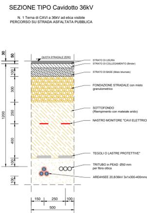
**SEZIONE TIPO Cavidotto 36kV su strada asfaltata - Scala 1:20**
