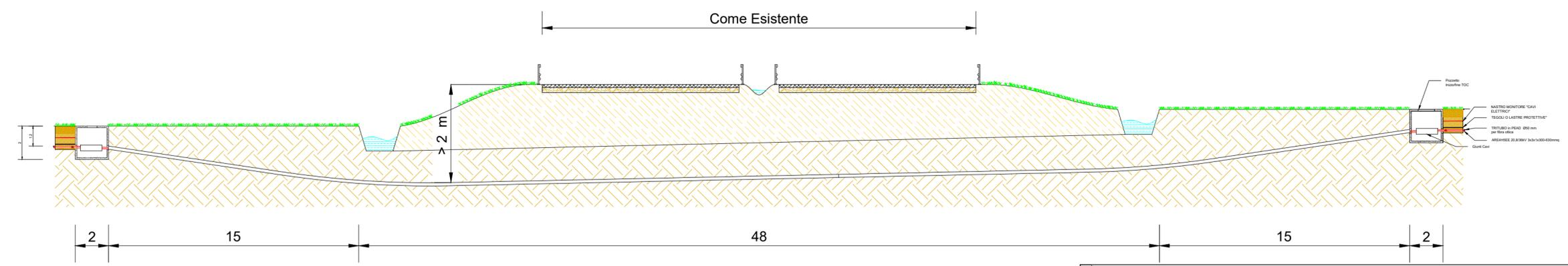
**SEZIONE TIPO Cavidotto - RISOLUZIONE Interferenza in INCROCIO tra cavidotti 36kV e Strada Statale 16 esistente - Scala 1:100**
