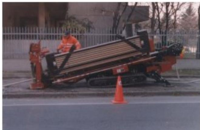
Fig. 3.1: Interrattore
