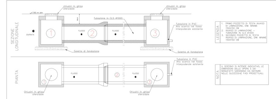
Sezione tipo di scarico acque meteoriche - Stazione Utente e Sede stradale
