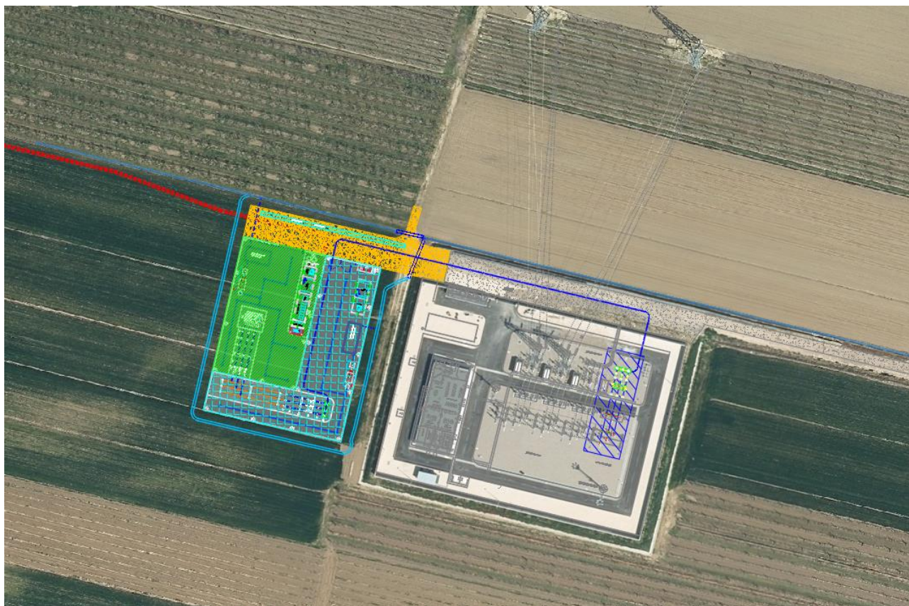
Figura 5-1: Stralcio planimetrico dell'area destinata a trasformazione urbanistica (in verde l'area della Stazione Utente, in azzurro a quadri l'area delle Opere Condivise, in giallo il prolungamento della strada di accesso da via degli Angeli)
